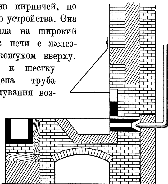
Рис. 2. Разрез кузнечного горна.
